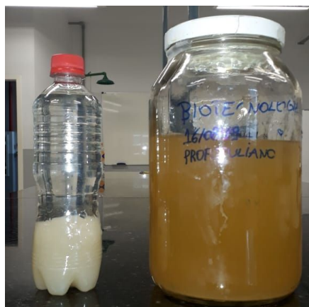
Figura 1 - lixiviado tratado e bruto do teste 1.
